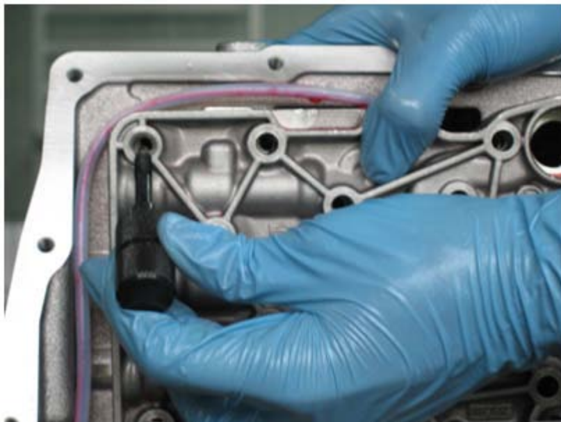
图 6: 专用工具(23K002-099-84312)固定液压控制块
