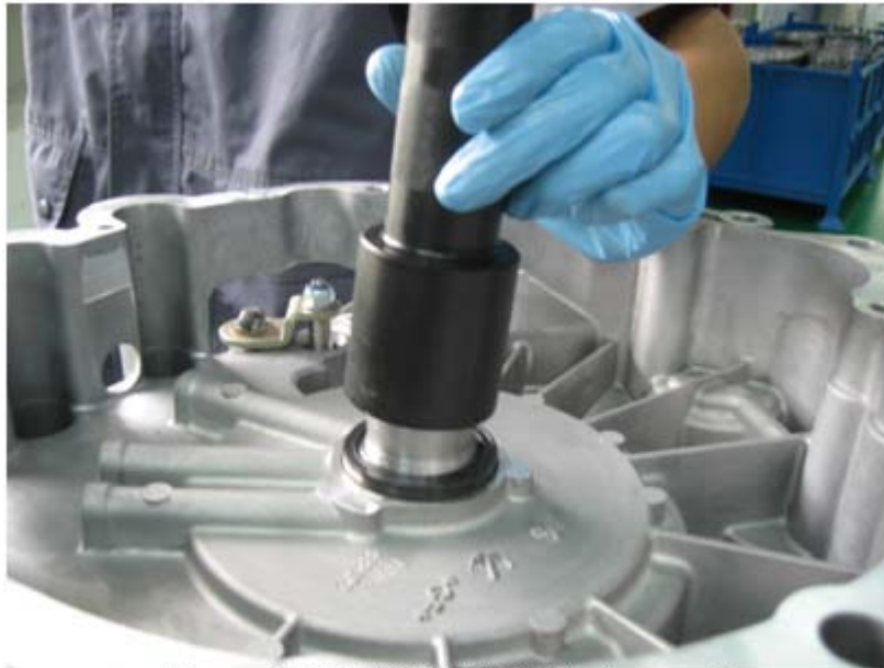
图 4: 用专用工具安装油封 (480130)
