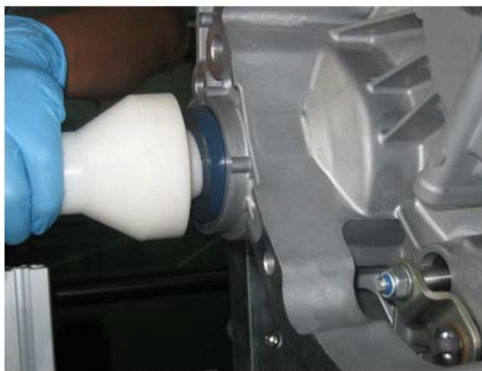
图 2 用特殊工具安装新的油封
