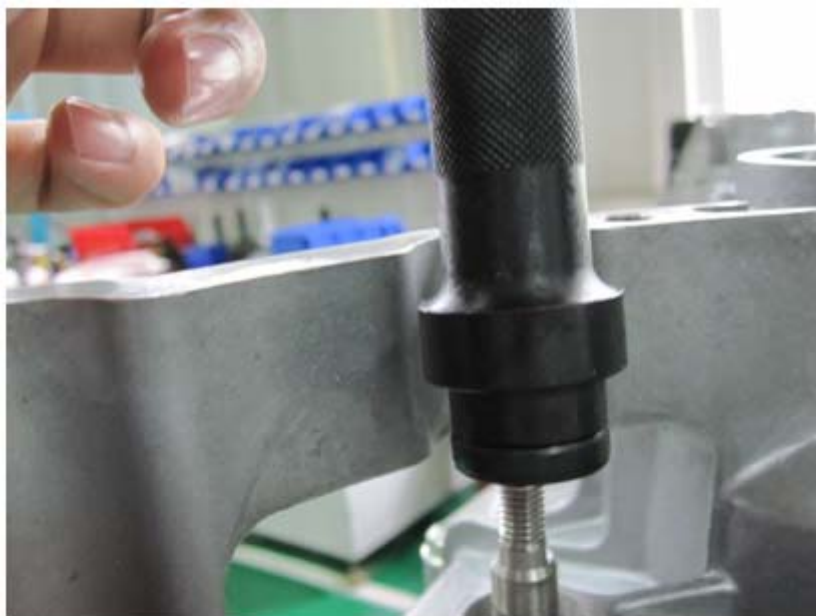
图 6：将安装好油封的冲头放置在换档轴上
