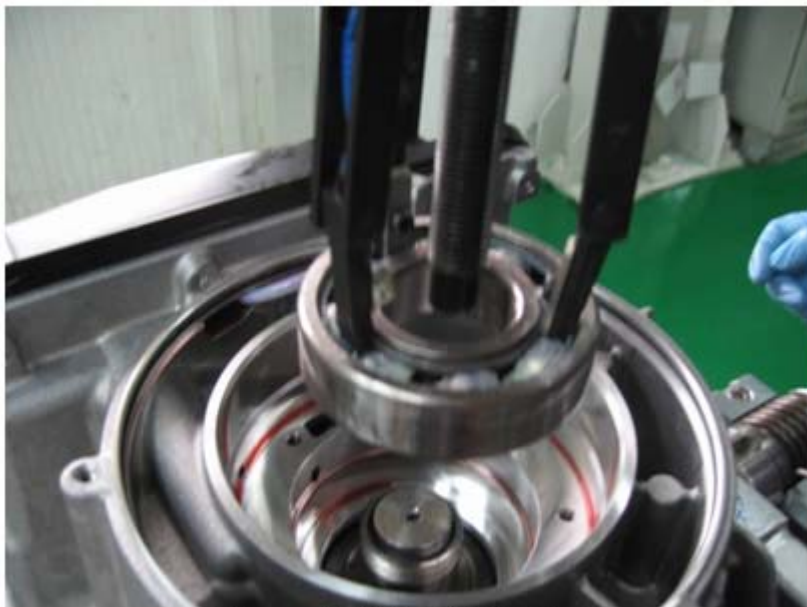
图 6: 拆下主动锥轮轴轴承
