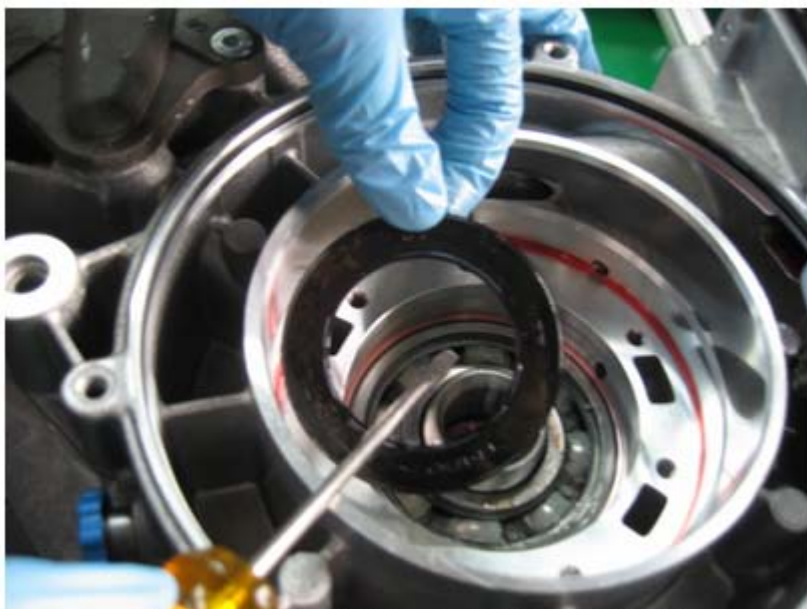
图 2：将主动锥轮轴承上的防尘罩取出
