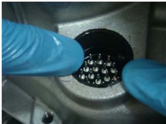
图 2: 将主接头压进变速箱内部
