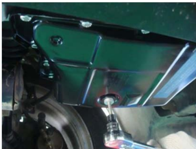
图 1 拆下放油螺塞
