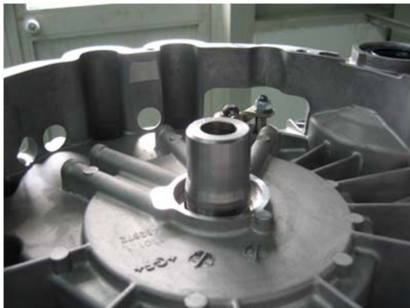
图 2: 将特殊工具装在输入轴上(480129)
