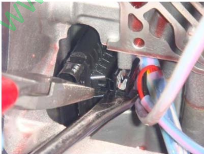
图 6: 将驾驶模式传感器接头压在壳体上
