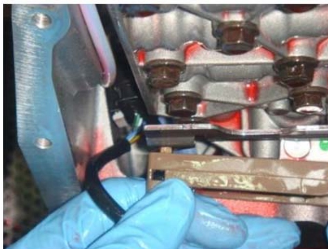
图 2: 将传感器往下压并取出
