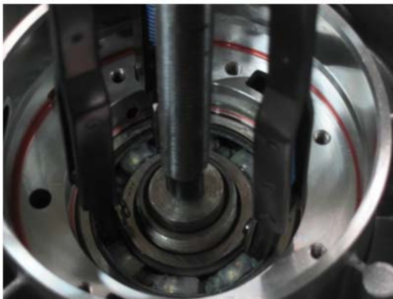
图 4: 组装轴承拆卸器 (480136)
