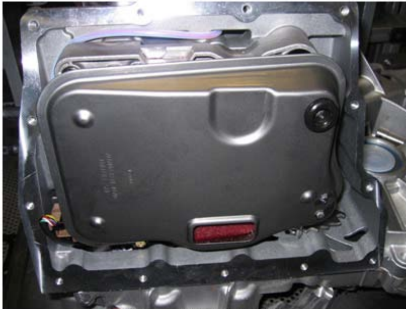
图 2: 将滤清安装到位
